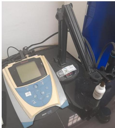
Gambar 3. Perangkat pH meter Orion 3 Star Plus
