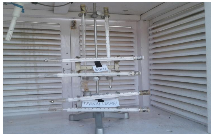
Gambar 1. Penempatan Termometer (Baru) dan Termometer Terkalibrasi.
