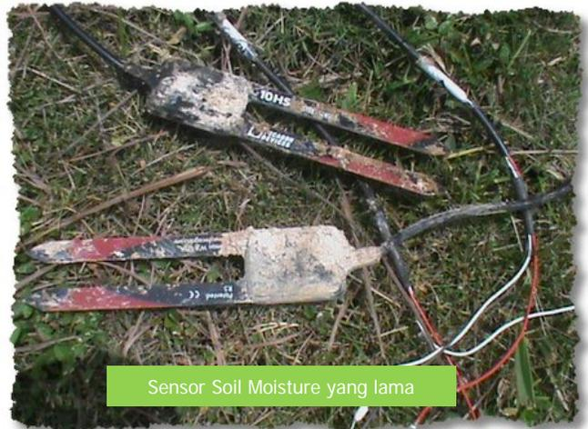
Sensor Soil Moisture yang lama
