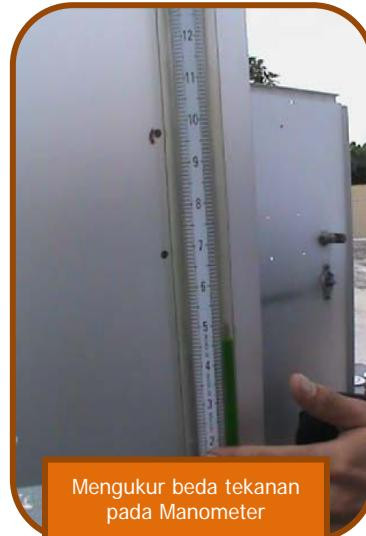
Mengukur beda tekanan pada Manometer
