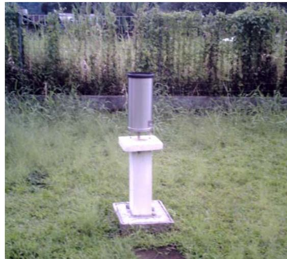
(b) Alat penakar hujan otomatis (*otomatic rain gauge*) untuk mengukur curah hujan di permukaan bumi secara langsung
