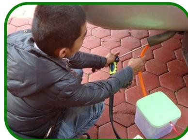
Proses Pengukuran emisi kendaraan bermotor, membandingkan antara prototipe alat Rahmi dengan portable CO Analyzer
