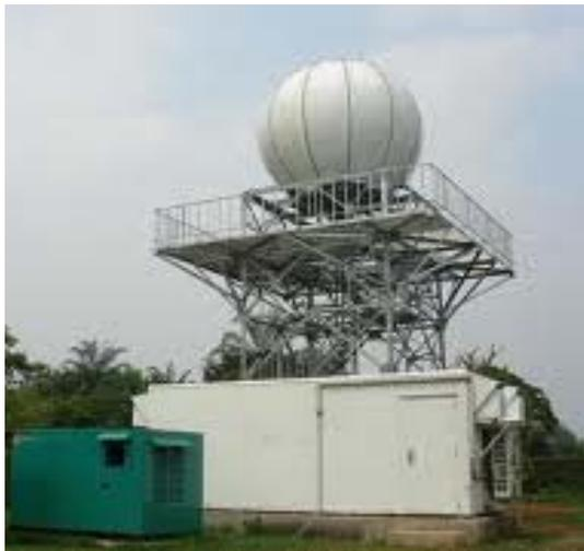
(a) Pengukuran curah hujan dari permukaan secara remote sensing dengan menggunakan *precipitation radar*
