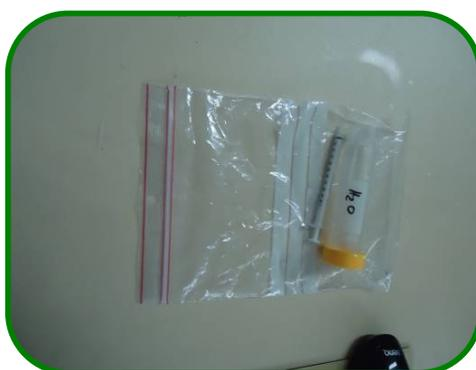
Peralatan sederhana pengujian pengaruh uap air terhadap pengukuran gas (syringe dan akuades/air bebas ion)
