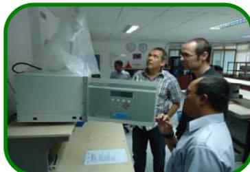
Melihat instrumen pengukuran aerosol PM 10- RAM 1020
