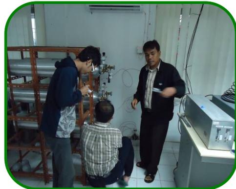
Proses Leak Check dilakukan untuk mencegah kebocoran gas standar, caranya catat kondisi tekanan regulator saat awal dan setelah 24 jam, bila terjadi penurunan berarti ada kebocoran
