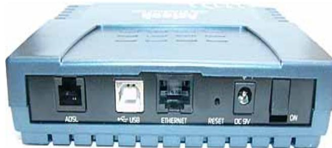
modem ADSL sederhana dilengkapi port USB dan ethernet
