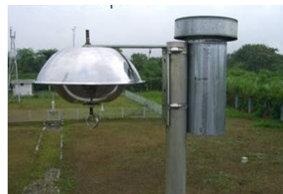
Gambar 9. Gambar Skema PUF Disk Sampler untuk POPs (kiri), Foto Pemasangan PUF Disk Sampler di Stasiun GAW Bukit Kototabang (kanan)
