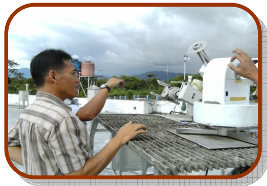
Ka BBMG Wilayah I mendapat penjelasan mengenai Eppley Pyrheliometer equipped with Smart Tracker (Alat pengukur radiasi matahari langsung)
