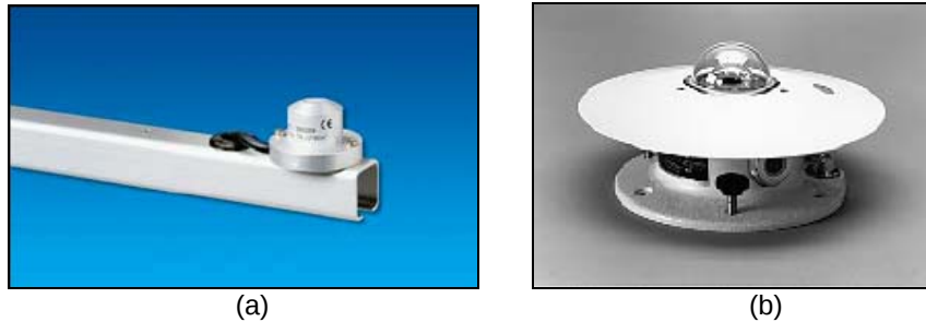
Gambar 2. Instrumen Piranometer QMS101 (a) dan Piranometer Eppley QPSP (b) yang terdapat di Bukit Kototabang
