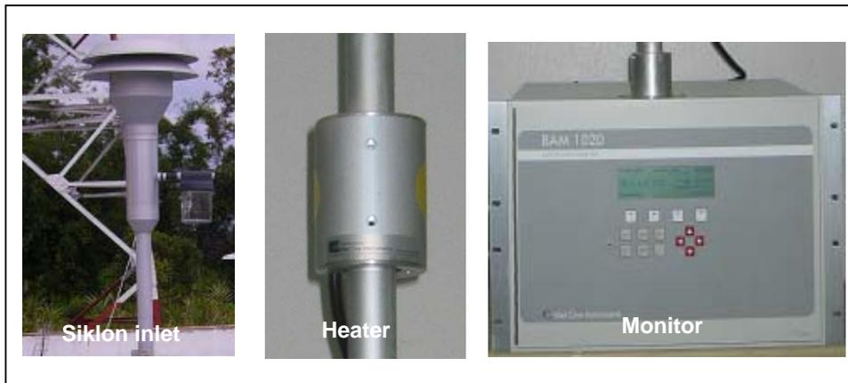
**Gambar 3.** Bagian dari instrumen BAM 1020
